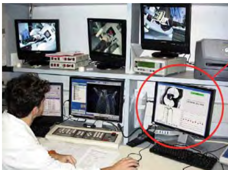
Figura 1 Sala comandi di un linac in cui è operativo il software DISO. Il risultato del test è messo in evidenza sul video indicato con un cerchio.
